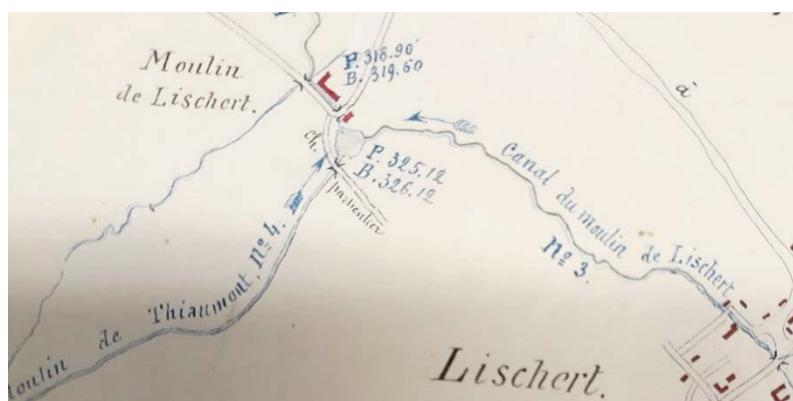
Ce canal alimentait l'étang du moulin de Lischert (en synergie avec une autre source). Sur un plan révisé en 1975 du cadastre apparaît un nom : "le canal du moulin".
